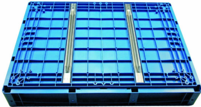
Bild 1: Stapelbara EURO – XL låda 800x600: Botten med stålinlägg innan bottenplattan gjuts samman.
